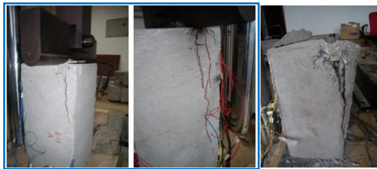
(c) extension of the vertical crack (d) fracture of specimen
